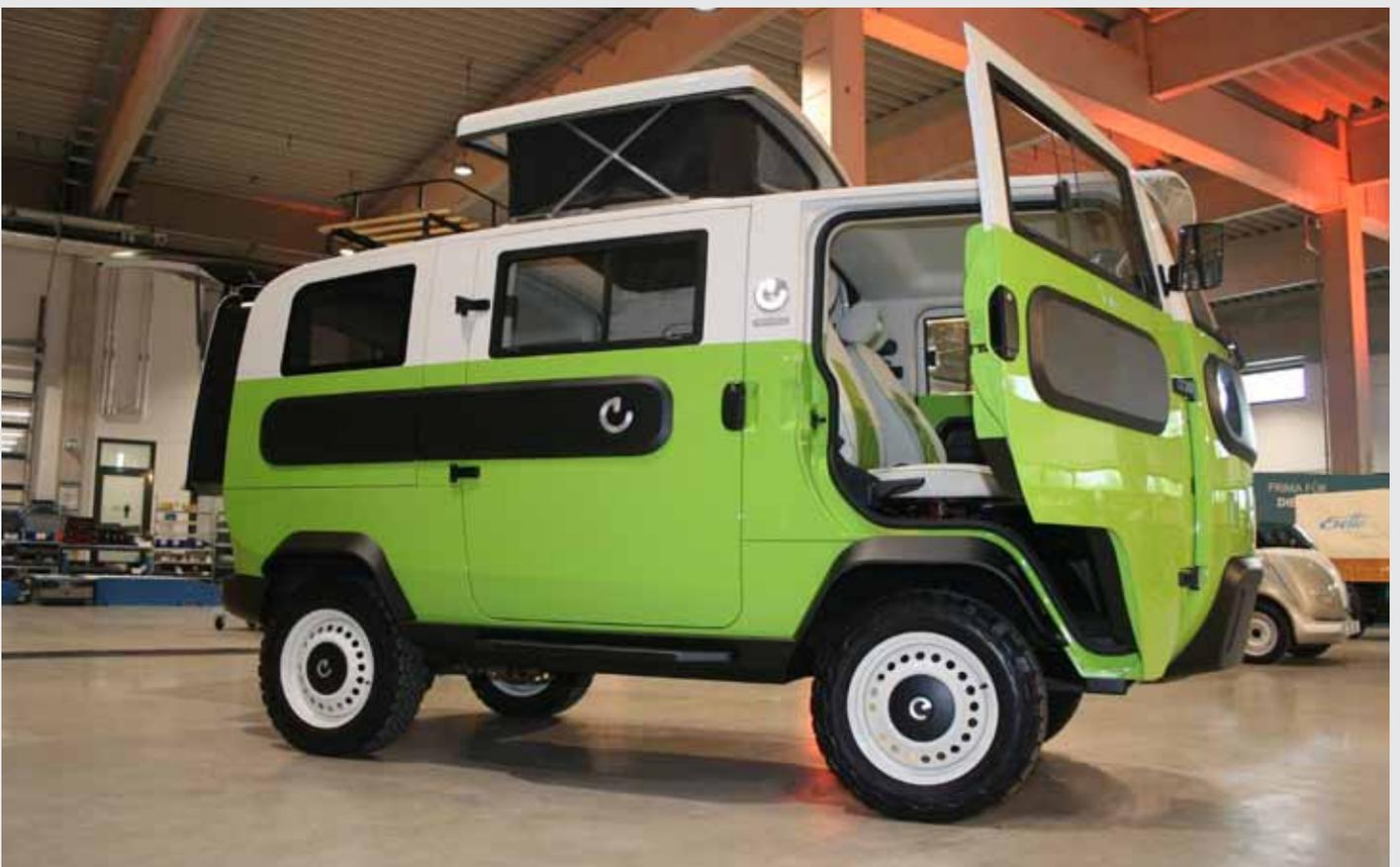
Der Motor des X-Bus wird eine Dauerleistung von 15 kW (20 PS) haben, wobei die Spitzenleistung bei bis zu 56 kW (76 PS) liegen kann. Entscheidender ist das angepeilte Drehmoment von etwa 1000 Newtonme-
