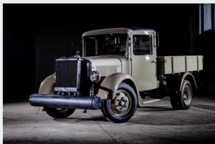
Mercedes-Benz L 1500 mit Holzvergaser (1937). Photo: Daimler Truck
