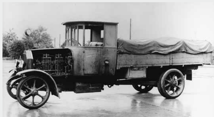
Mercedes-Benz Typ 5K3, der erste Diesel-Lkw der Welt (1923). Photo: Daimler Truck
