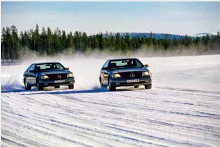
Mercedes-Benz S-Klasse Coupé der Baureihe 140 mit (rechts) und ohne Elektronischem Stabilitätsprogramm ESP®. Foto aus dem Jahr 1994 bei Tests in Arjeplog, Schweden. (Foto Mercedes-Benz Classic)
