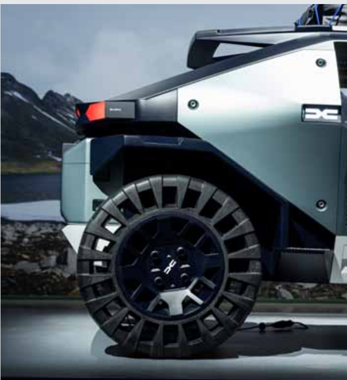
Eine minimalistisch wirkende Bereifung mit geringem Verschleiss und Pannensicherheit
