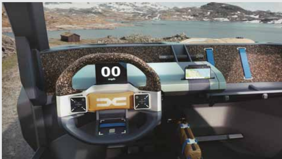
Karosserie und Innenausstattung aus recycelten Kunststoffen und Naturstoffen wie Kork, witterungsfest, robust und leicht zu pflegen
