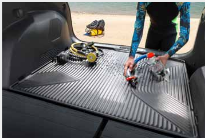
Kia hat für den EV3 eine Kofferraumschale entwickelt, die zu 40 Prozent aus recyceltem Plastikmüll aus dem Meer besteht.
