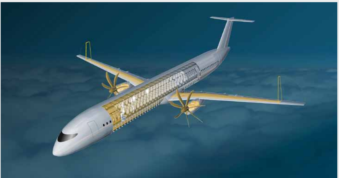
Flugzeugkonfiguration Wasserstoff-Mild-Hybrid mit Wasserstoff-Direktverbrennung und Brennstoffzellen zur Unterstützung. Wasserstoff-betriebene Flugzeuge können die Klimaauswirkungen um mindestens 80 Prozent reduzieren.
