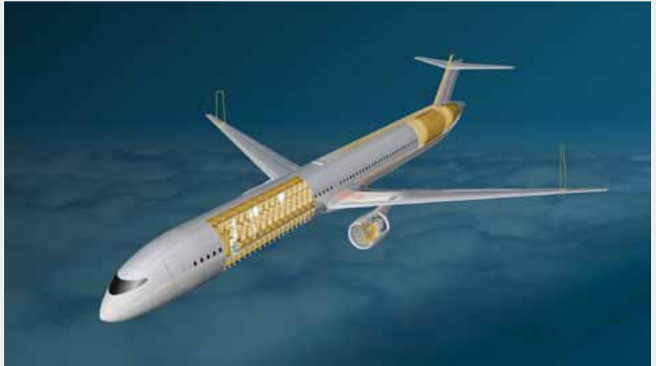
Flugzeugkonfiguration Plug-in-Hybrid: Reichweite 500 Kilometer batterieelektrisch, hybrid-elektrisch zusätzlich mit nachhaltigen Treibstoffen bis zu 2800 Kilometer.
