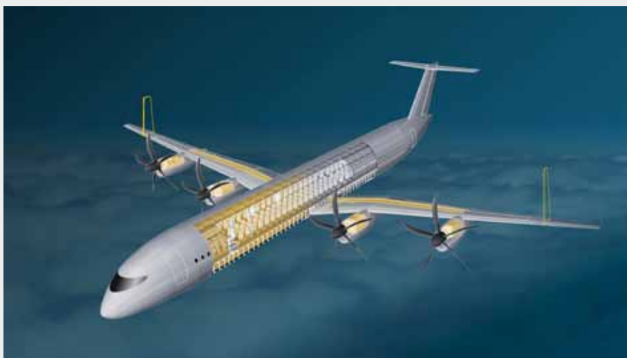
Flugzeugkonfiguration Plug-in-Hybrid: Reichweite 500 Kilometer batterieelektrisch, hybrid-elektrisch zusätzlich mit nachhaltigen Treibstoffen bis zu 2800 Kilometer.
