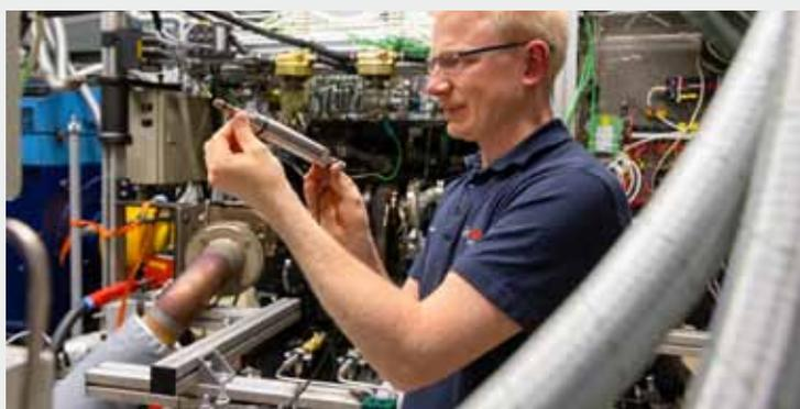
Bosch arbeitet am Wasserstoffmotor und entwickelt verschiedene Komponenten. Der Injektor für die Direkteinblasung kommt dabei ohne zusätzliche Schmierung aus.
