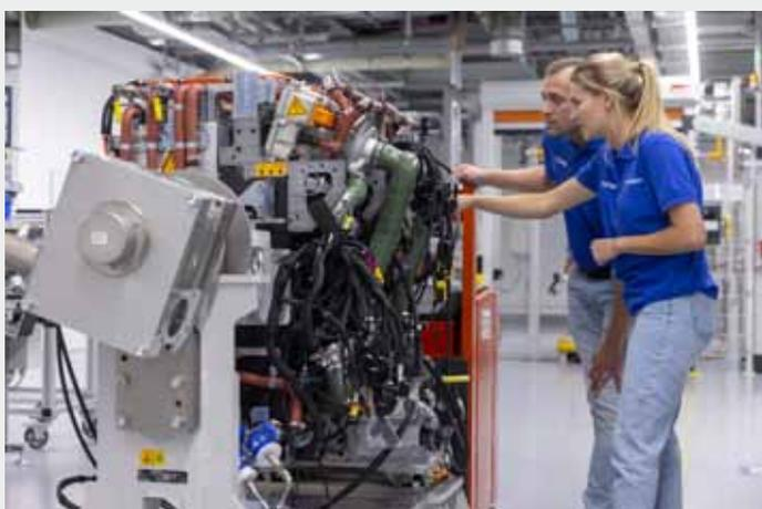
Bosch fertigt das Fuel Cell Power Module für Nutzfahrzeuge seit 2023 in Stuttgart-Feuerbach. Das Antriebssystem für brennstoffzellenelektrische Fahrzeuge ist hochintegriert und besteht aus mehreren hundert Einzelteilen.
