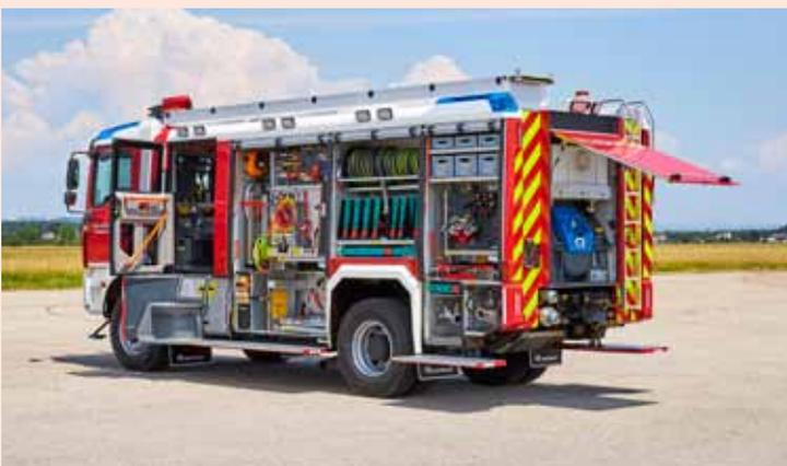
Ein weiterer Vorteil der in den Aufbau integrierten Kabine ist die durchgängige Dachfläche, die für Beladezwecke optimal genutzt und sicher betreten werden kann. Durch die formschlüssige Verbindung von Fahrerhaus und Mannschaftskabine mit dem Aufbau konnten zudem fahrdynamische Verbesserungen erzielt werden.
