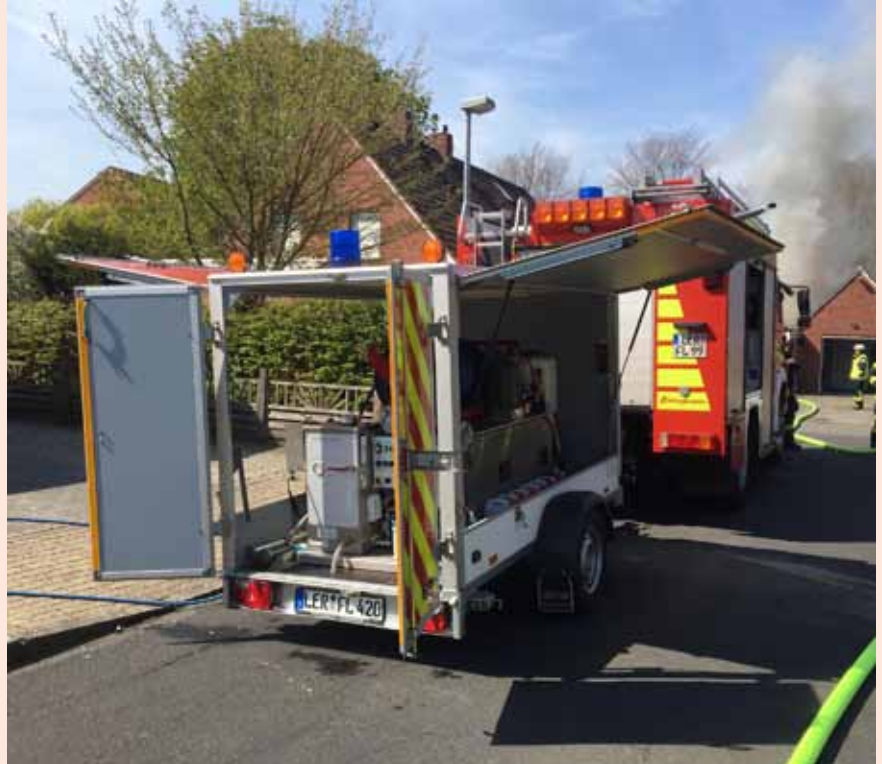
Das in einem Anhänger verbaute Feuerlöschsystem Cobra
