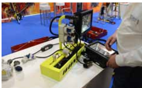
Dönges Neuheiten wie Lichtbrücke mit LED-Scheinwerfer , Fuß der Scheinwerfer auf der Brücke verstellbar
