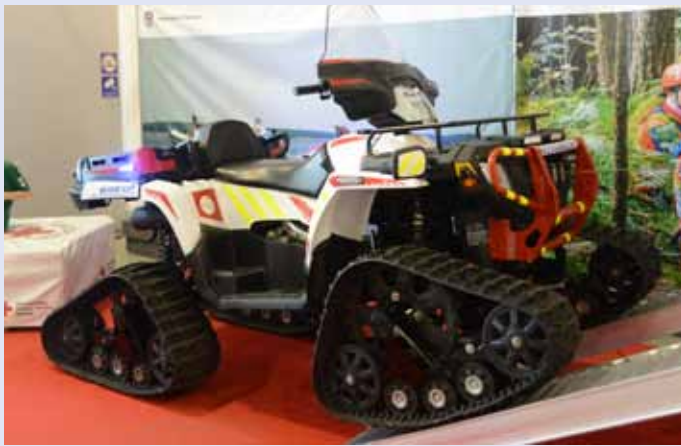
Quad-Rettungsfahrzeug mit Kettenaufsatz für die Berg- und Höhlenrettung des DRK Sachsen Hersteller: Polaris
