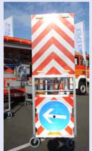
Verkehrssicherungs- Container mit LED-Blitzer, Batterie und Platz für Verkehrsleitkegel, ausgestellt bei der Fa. Hensel
