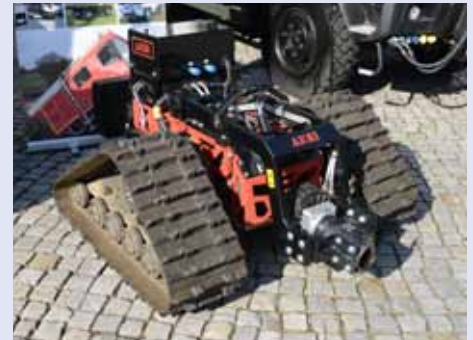
Kettenrettungsgerät mit Fernsteuerung für unterschiedliche Aufsätze mit Nebenantrieb und Hydraulikkompressor
