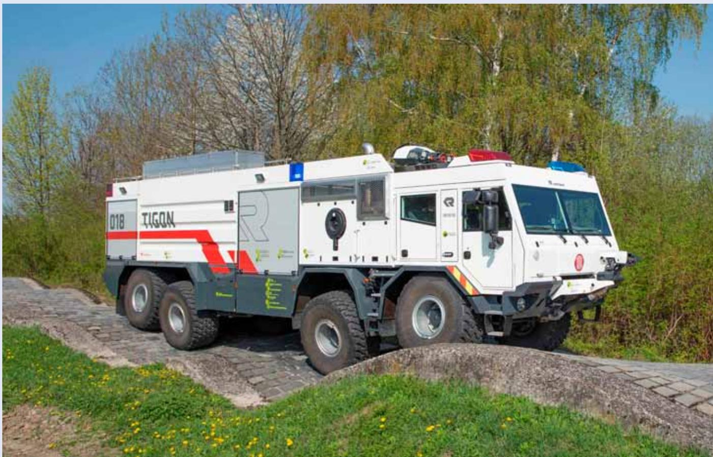
**Linz (A).** Das Großtanklöschfahrzeug der Extreme stellt Rosenbauer vor. Die Wahl des Fahrgestelles fiel auf das extrem geländegängige Backbone-Tube-Chassis von Tatra. Alles an diesem Fahrzeug ist auf seine Geländegängigkeit, seine funktionale Variabilität und seine Löschtechnik ausgelegt. Der TIGON ist mit dem volumenstärksten Löschsysteme von Rosenbauer verbaut.
