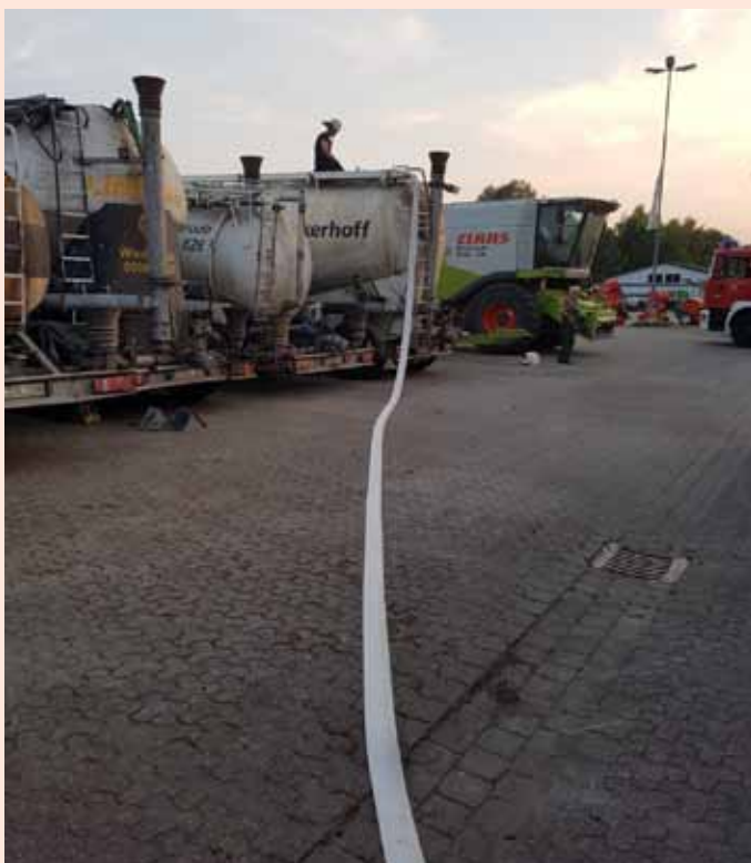
Eine lange Schlauchleitung dient der Befüllung der Gülletank-Anhänger
